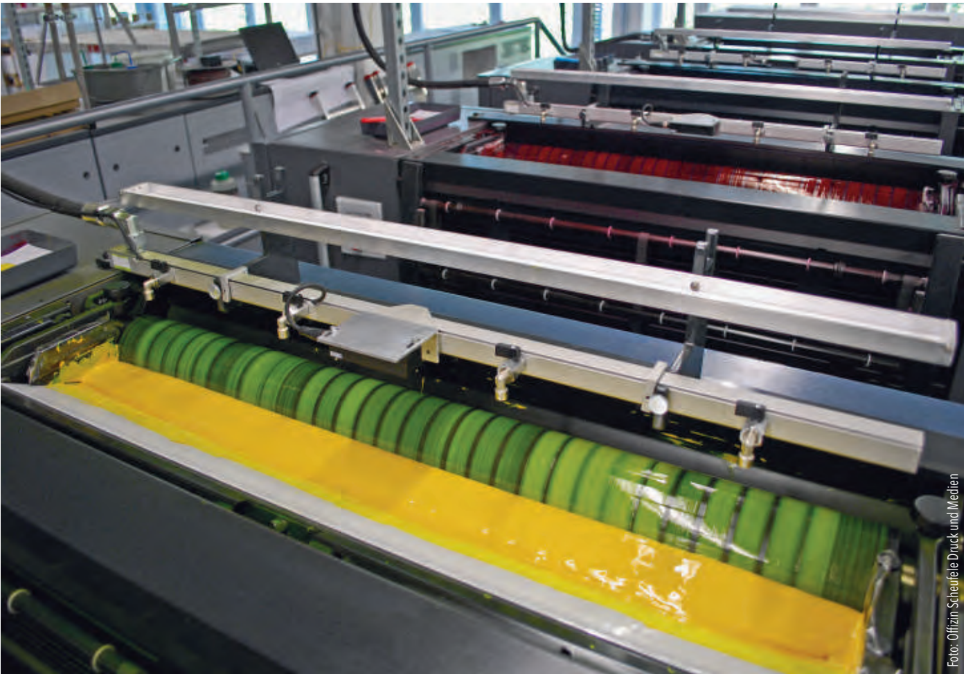
Im LE-UV-Verfahren werden spezielle Druckfarben verwendet, die nicht länger als sechs Monate gelagert werden sollten.
